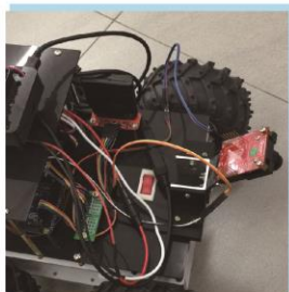
程控搭載Arduino Mega、Raspberry Pi，操作容易，擴充自由度高
